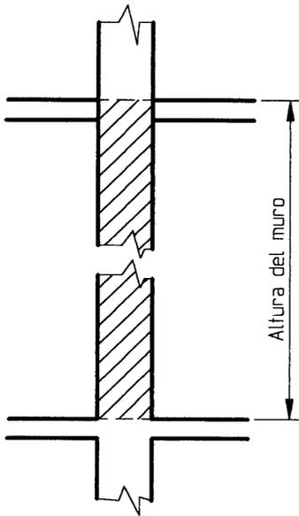
Zonas comunes a losas y muros de hormigón armado, sin interposición de vigas, se computan como pertenecientes al muro inferior (ver 6.4.1)
