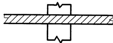
Losa de hormigón armado apoyada sobre elemento de diferente naturaleza (ver 6.7.5)
