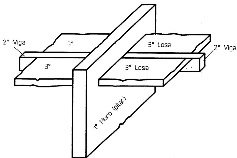
Orden de precedencia en la medición de partes comunes a muros (pilares), vigas y losas (ver 6.10.2)
